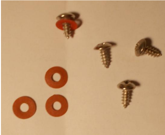
Befestigungsschrauben 3 X 10 mm Isolierscheiben Ø innen 3 mm außen 8 mm
